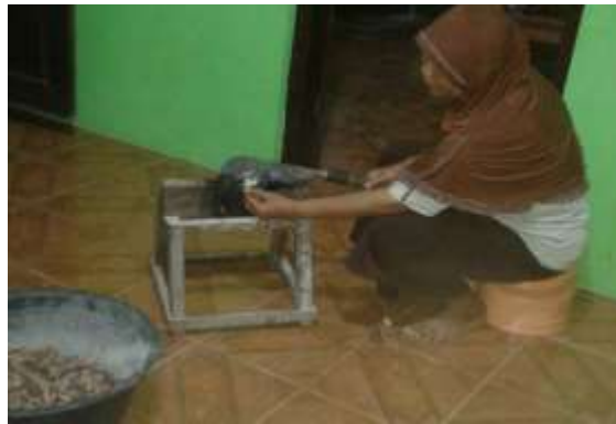
Gambar 1. “Kecip” Alat pengupas biji mete
