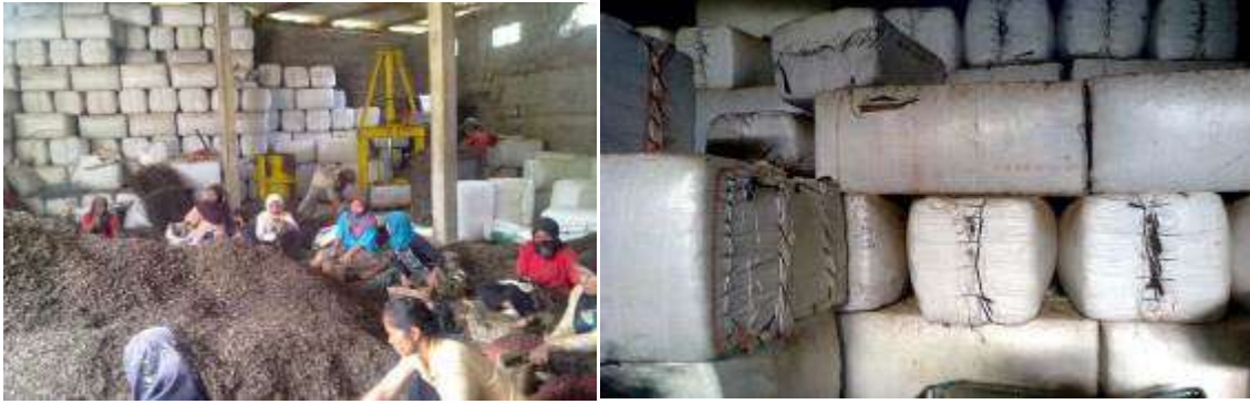
Gambar 3. (a) Proses pencacahan jaggelan yang sudah dikeringka di KUB Bumi Makmur; (b) Proses pengepresan jaggelan kering kedalam sak kemasan
