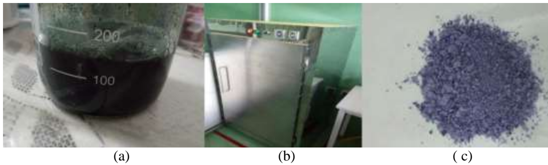
Gambar 3. Pembuatan Fikosianin di Laboratorium : (a) Ekstraksi Fikosianin (b) Pengeringan dengan Oven (c) Hasil Fikosianin yang dibuat di Laboratorium
